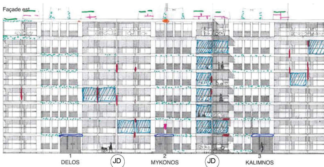
Analyse de l'état existant : interventions passées et repérage des pathologies (bâtiment A, façade est)
